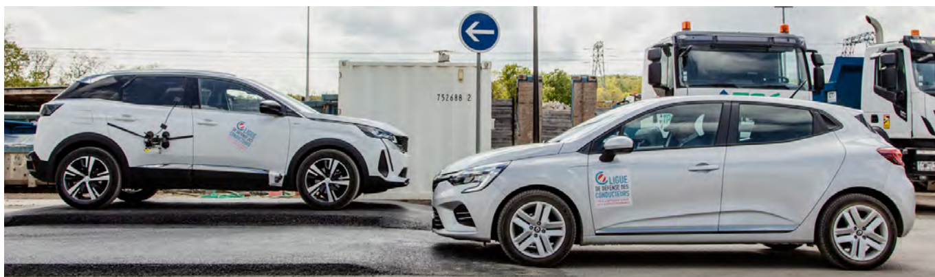
Caractéristiques techniques des deux véhicules testés : Peugeot 3008, 3 cylindres 1,2 litre PureTech EAT8 de 130 ch (2021) – Renault Clio 3, cylindres 1 litre essence X-Tronic de 90 ch (2021)
